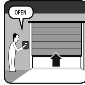
PULSAR ABRIR TAPA PARA BUSCAR LIMITE SUPERIOR
