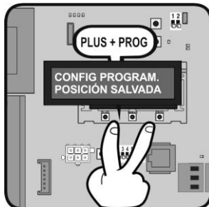
PULSAR PLUS + PROG PARA GUARDAR POSICIÓN ABIERTA
