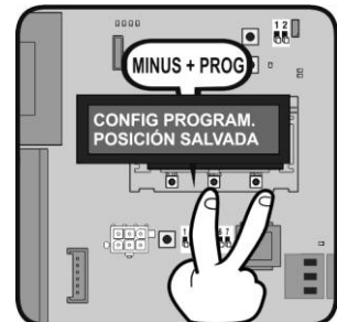
PULSAR MINUS + PROG PARA GUARDAR POSICIÓN CERRADA
