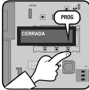
PULSAR PLUS + PROG PARA GUARDAR POSICIÓN ABIERTA
