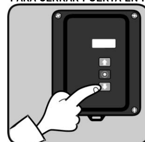
PULSAR ↓ TAPA Y MANTENER PARA CERRAR PUERTA EN HP
